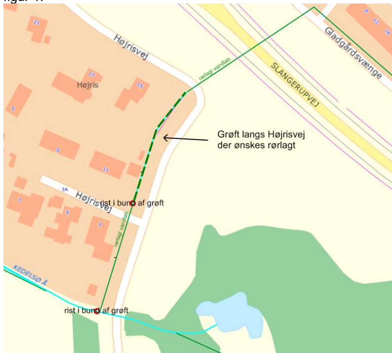
Figure 1. Skærmkort der viser et udsnit af lokalområdet ved Højrisvej. Grøften der ønskes rørlagt er beliggende syd for Slangerupvej og parallelt med Højrisvej 11-15. Grøften er på kortet markeret med grøn stiplede linje.
